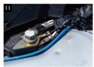
●正常に作動させるために本体から伸びる黒 線を金属部分に接続してボディアースを取る
