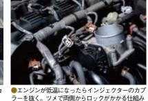
ラーを抜く。ツメで両側からロックがかかる仕組み
