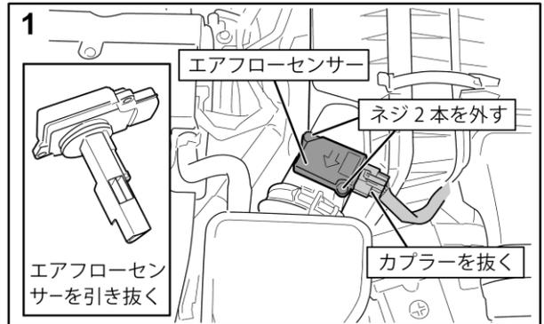
1. エアフローセンサーのコネクタを抜き、固定ネジ2本をはずしエアフローセンサーをエアクリーナーBOXより抜いて下さい。
