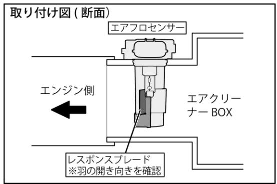
4. レスポンスブレードのフックをペンチを使用してカシメてエアフローセンサーにしっかりと固定をします。
