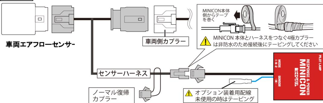
**エアフローセンサーへの取り付け**
