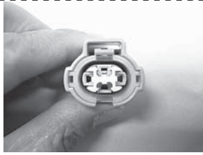
6. 「2」で外した白い部品を取付して圧カススイッチへ接続します。
